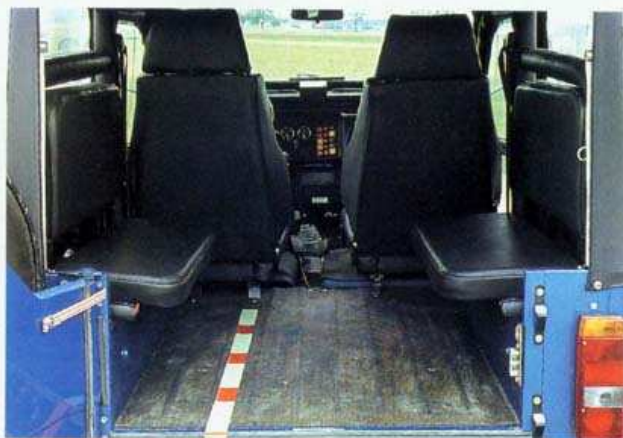
Größter Vorzug der spartanischen Doppelsitzbänke im Heck ist der Hochklappmechanismus, der sie platzsparend an der Außenwand verschwinden läßt
